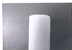
2. Rohrende auf 45° Winkel entgraten
